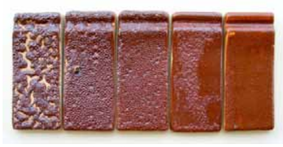
Şekil 20. Kil –Nefelin Siyanit denemeleri 1250 °C Figure 20. The test of Clay Nepheline Syenite 1250 °C
