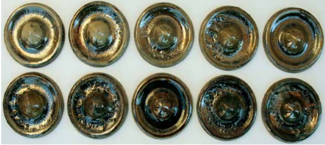
Şekil 4. Reçete ES2'in Oksidasyonlu Atmosferdeki Görsel Sonuçlar
