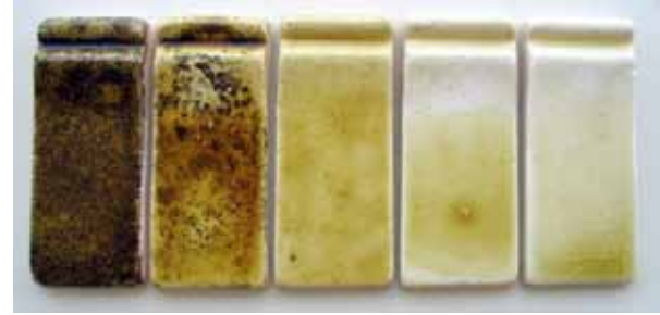
Şekil 5. Kil - Üleksit denemeleri 1040°C Figure 5.the test of Clay – Ulexite 1040 °C
