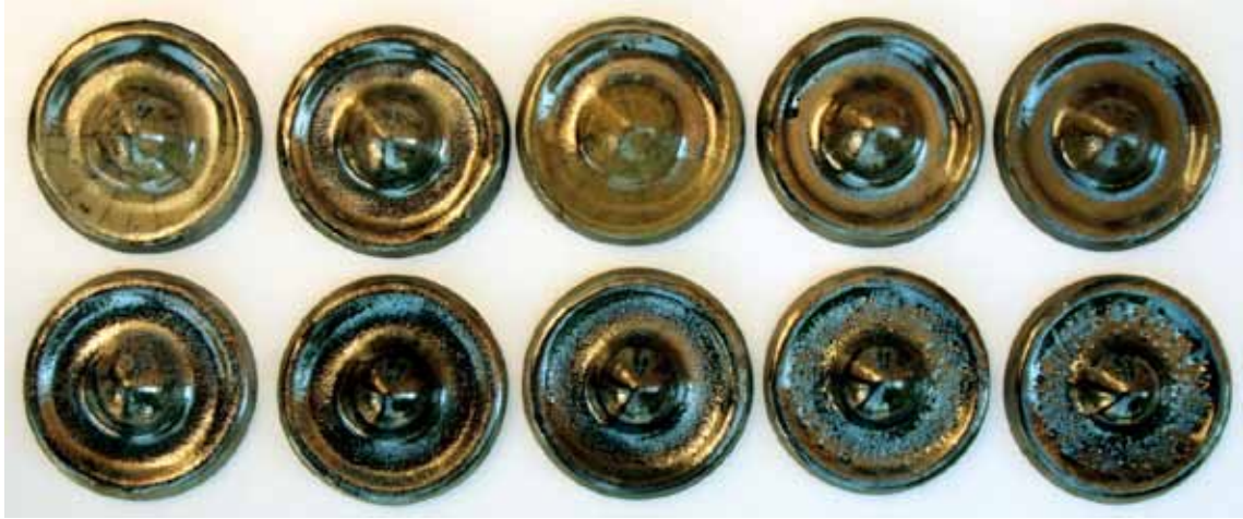
Şekil 7. Reçete ES3'in Redüksiyonlu Atmosferdeki Görsel Sonuçları
