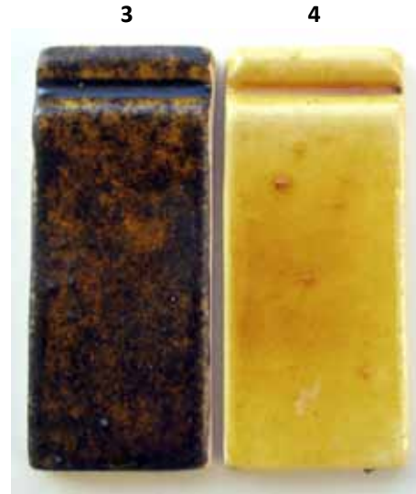
Şekil 25. Kil-sülyen-üleksit 1040°C Figure 25. Clay- Red Lead- Ulexide 1040°C
