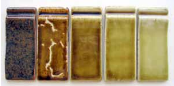
Şekil 15. Kil – Üleksit denemeleri 1250°C Figure 15. The test of Clay – Ulexite 1250 °C
