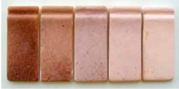
Şekil 10. Kil – Nefelin Siyanit denemeleri 1040°C Figure 10. The test of Clay – Nepheline Syenite 1040 °C
