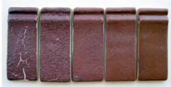
Şekil 14. Kil - Ortoklas denemeleri 1250°C Figure 14. The test of Clay – Orthoclase 1250 °C
