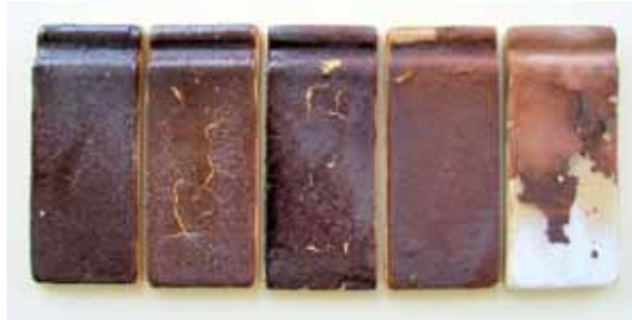
Şekil 16. Kil - Potas denemeleri 1250°C Figure 16. The test of Clay – Potas 1250 °C
