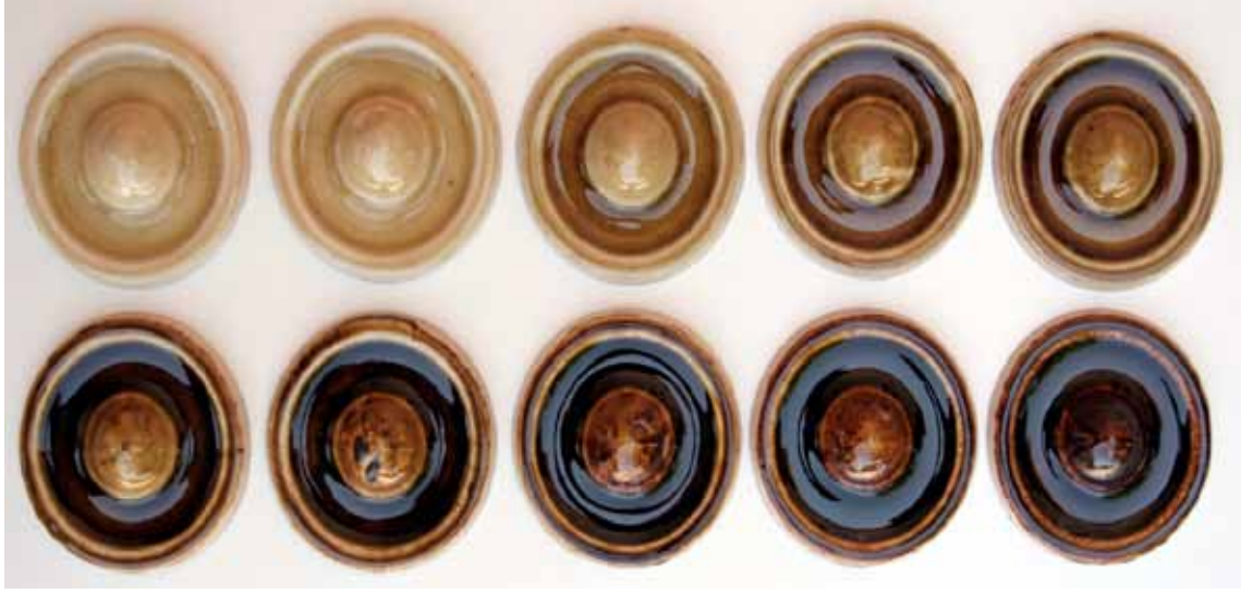
Şekil 4. Reçete ES2'in Oksidasyonlu Atmosferdeki Görsel Sonuçlar
