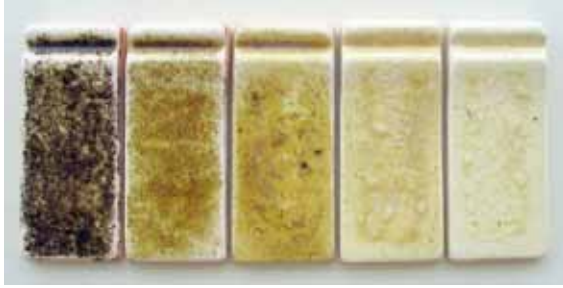
Şekil 8. Kil - Kolemanit denemeleri 1040°C Figure 8. The test of Clay – Colemanite 1040 °C
