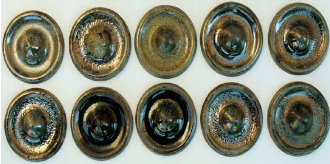
Şekil 3. Reçete ES1'in Redüksiyonlu Atmosferdeki Görsel Sonuçları
