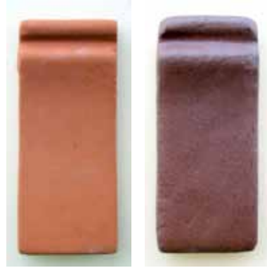
Şekil 1. Çanaklı köyü kilinin 1040 °C ve 1250 °C' lerdeki pişme rengi Figure 1. Çanaklı Village of 1040 °C and 1250 °C firing color of the clay
