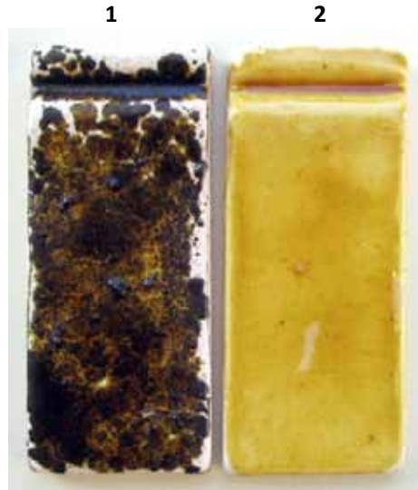
Şekil 24. Kil-sülyen-kolemanit 1040°C Figure 24. Clay- Red lead- Colemanite 1040°C
