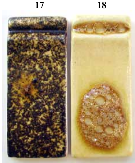
Şekil 32. Kil-üleksit-kalsine boraks 1040°C Figure 32. Clay-Ulexide- C. Borax 1040°C
