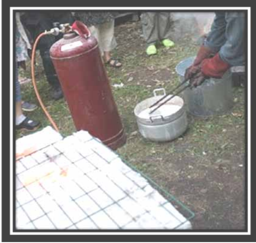
Şekil 20. Formlar önceden hazırlanmış olan sıvı karışımına daldırılır.
