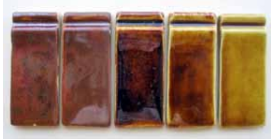
Şekil 12. Kil - Sülyen denemeleri 1250°C Figure 12. The test of Clay – Red lead 1250 °C
