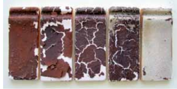
Şekil 11. Kil – Sodyum Nitrat denemeleri 1040°C Figure 11. The test of Clay – Sodium Nitrite 1040 °C
