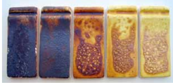
Şekil 2. Kil - Sülyen denemeleri 1040 °C Figure 2. The test of Clay – Red Lead 1040 °C
