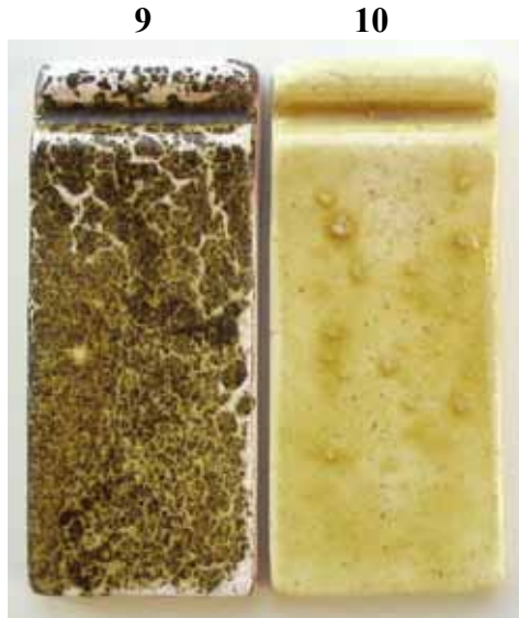
Şekil 28. Kil-kolemanit-üleksit 1040°C Figure 28. Clay- Colemanite-Ulexide 1040°C
