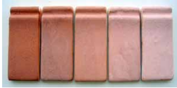
Şekil 4. Kil - ortoklas denemeleri 1040°C Figure 4. The test of Clay – Orthoclase 1040 °C
