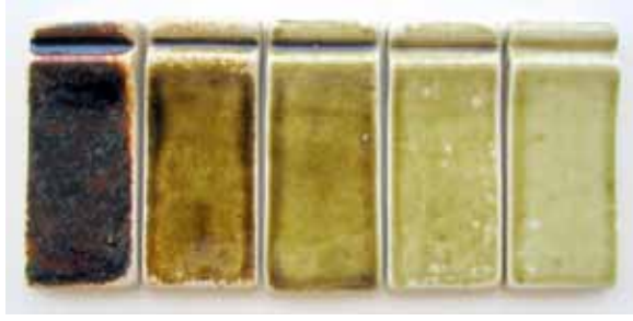
Şekil 18. Kil - Kolemanit denemeleri 1250°C Figure 18. The test of Clay – Colemanite 1250 °C
