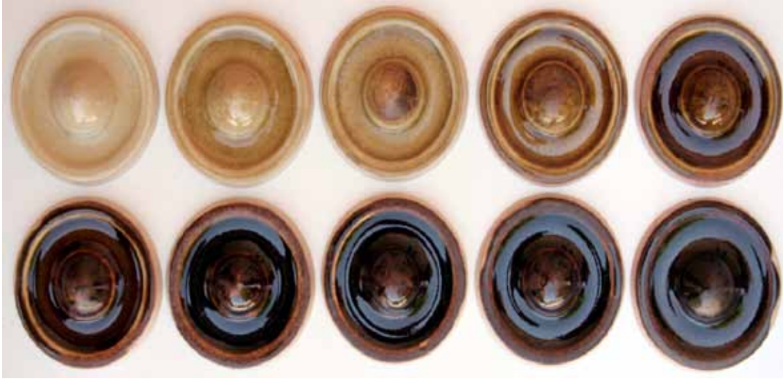
Şekil 2. Reçete ES1'in Oksidasyonlu Atmosferdeki Görsel Sonuçları
