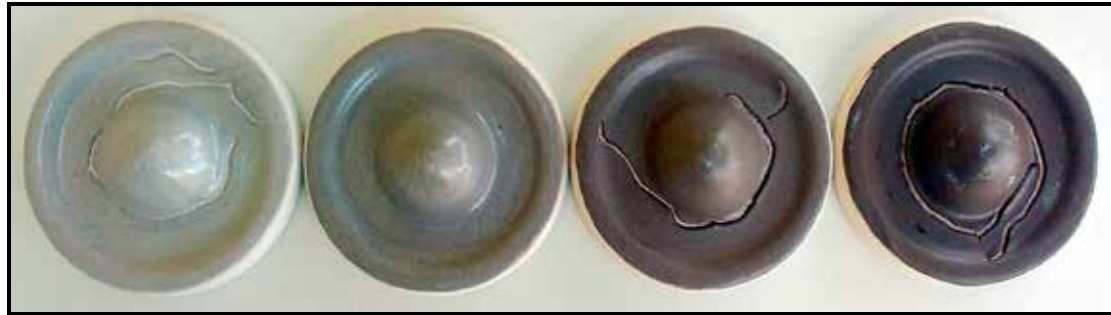
Şekil 6. Uçucu Kül-Frit Karışım Sırların Pişirme Sonuçları (1000 °C)
