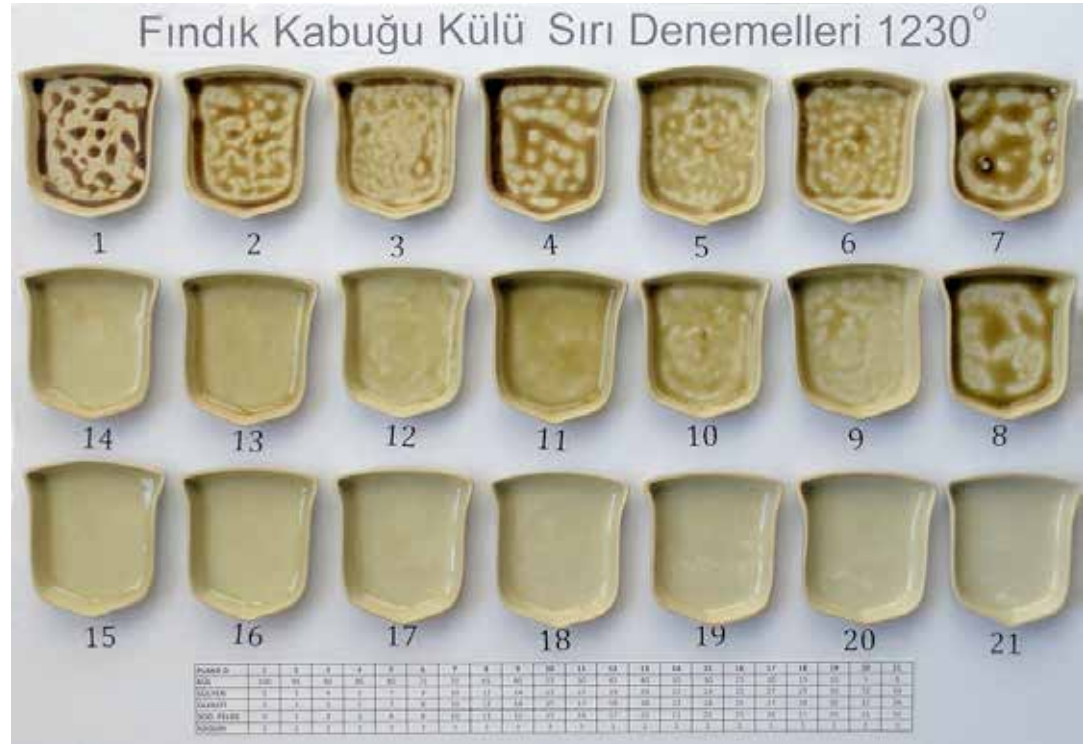
Şekil 11: Fındık Kabuğu Külü, Sülyen, Üleksit, Sodyum Feldspat ve Kaolin Karışımli Sırlar Figure 11: Hazelnut Shell Ash, Lead, Ulexite, Sodium Feldspar and Kaolin Mixed Glazes
