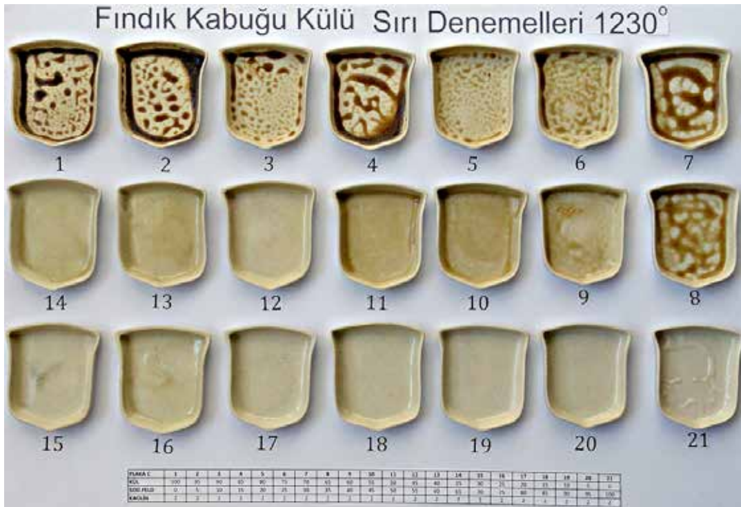
Şekil 10: Fındık Kabuğu Külü, Sodyum Feldspat ve Kaolin Karışımli Sırlar Figure 10: Hazelnut Shell Ash, Sodium Feldspar and Kaolin Mixed Glazes
