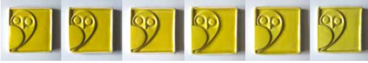
Şekil 2. Sarı karo sırnın bisküvi plakalar üzerinde 950 0 C, 1000 0 C, 1050 0 C, 1100 0 C, 1150 0 C ve 1200 0 C’de deneme pişirimi sonuçları.
