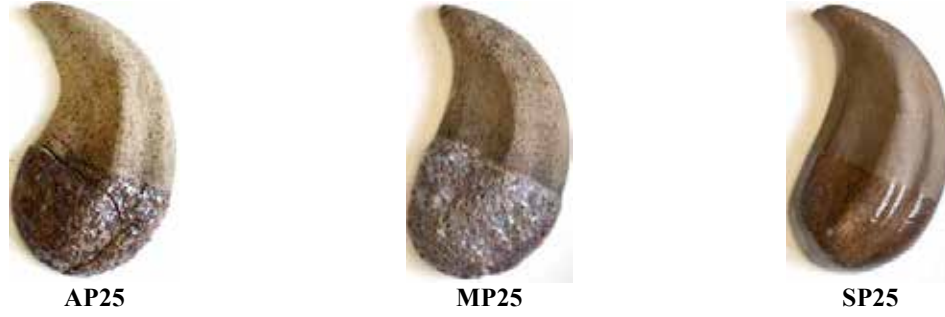
Şekil 4. Pil atıkları ile yapılmış temsili deneme tabletleri Figure 4. Representative samples made with waste batteries
