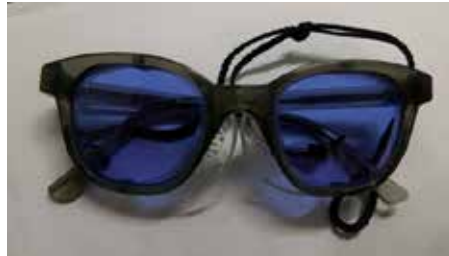
Şekil 7: Açık alevde kullanılan didymium cam çalışma gözlüğü Figure 7: Flameworking equipment didymium glasses
