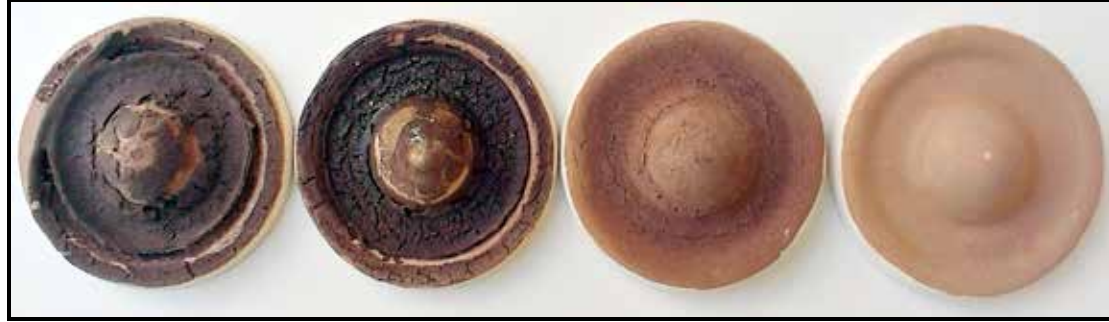
Şekil 2. Uçucu Kül-Üleksit Karışımli Sırların Pişirme Sonuçları (1000 °C)
