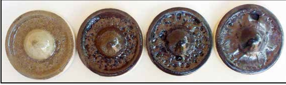
Şekil 7. Uçucu Kül-Frit Karışıklı Sırların Pişirme Sonuçları (1200 °C)
