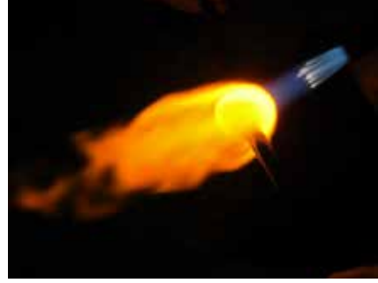
Şekil 3: Propan gazı ( C_3H_8 ) ve Oksijenin ( O_2 ) oluşturduğu alev ile ergiyen cam Figure 3: Glass melting by the flame created by Propane Gas ( C_3H_8 ) and Oxygen ( O_2 )
