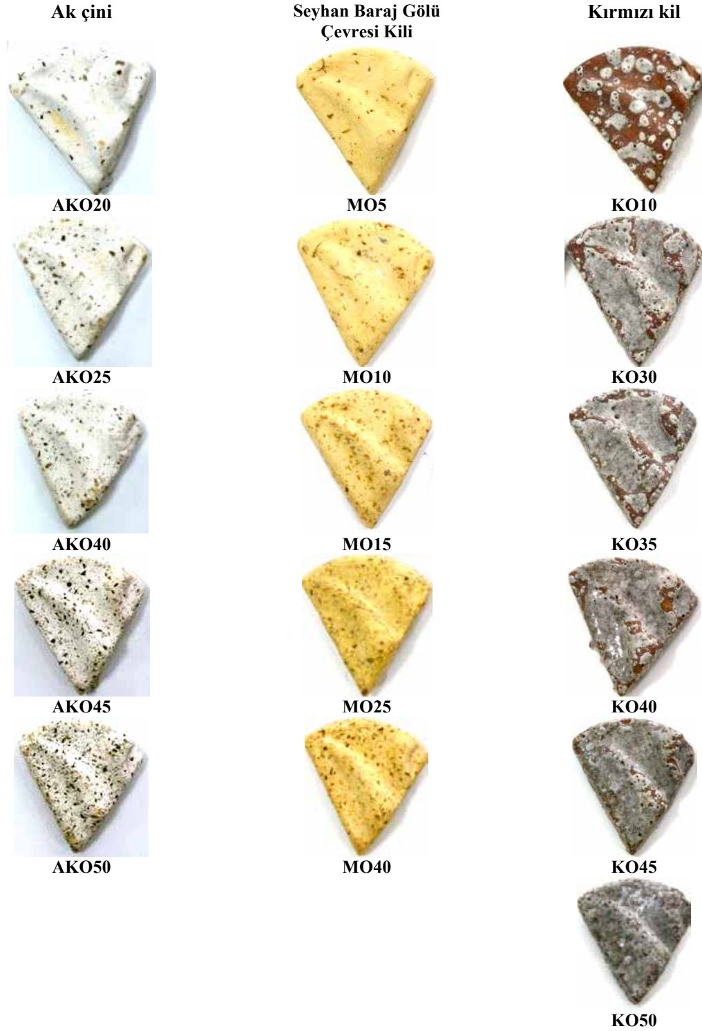
Şekil 3. Oto camı atıkları ile yapılmış temsili deneme tabletleri Figure 3. Representative samples made with auto glass waste
