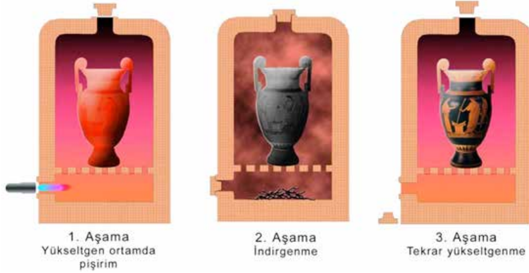
Şekil 2. Üç aşamalı pişirim yöntemi ile siyah terra sigillata türü seramik elde edilmesi [28]. Figure 2. Production of black terra sigillata type ceramic using three-stage firing technique [28].
