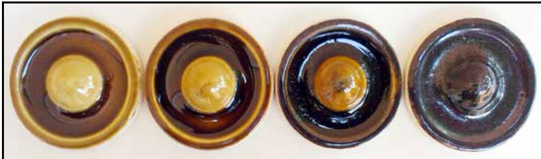
Şekil 5. Uçucu Kül-ÜSSF Karışım Sırların Pişirme Sonuçları (1200 °C)
