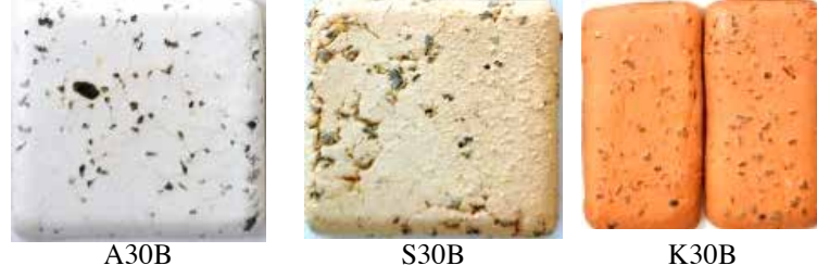
Şekil 1. Seramik çamuru-cüruf karışımlarının 1000°C bisküvi pişirimlerine ait görüntüler
