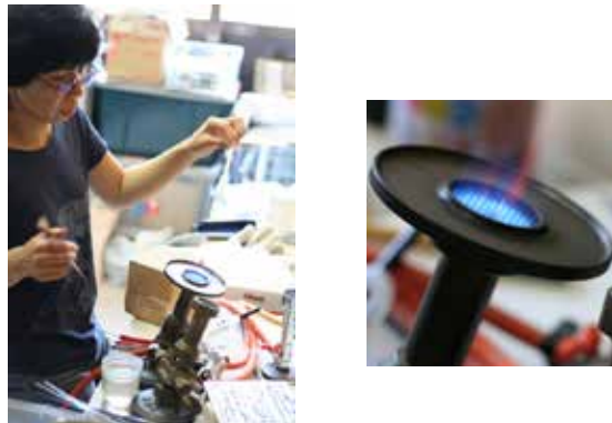
Şekil 21,22: Açık alevde cam şekillendirme şaloması ve ayrıntı Figure 21,22: Flameworking tool and close-up view
