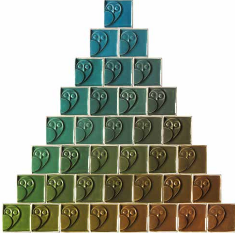
Şekil 4. Üçlü sistem sır diyagramı ile hazırlanmış 36 adet sırın renk geçiş düzeni. Figure 4. 36 different color glazes that prepared with trio system glaze diagram.
