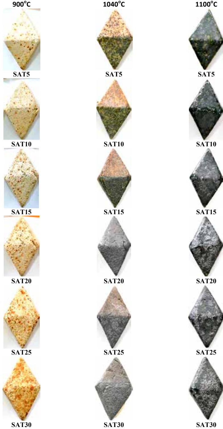
Şekil 8. Söğüt Kili ve Anahtar Talaşı ile yapılmış temsili deneme tabletleri Figure 8. Representative samples made with Söğüt clay and key shavings
