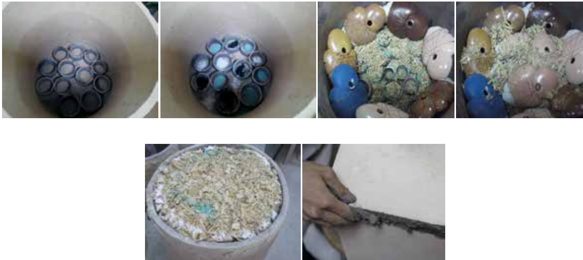
Şekil 4. Plakaların Sagar Kutusuna Yerleştirilme Aşamaları
