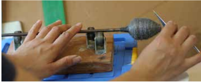
Şekil 10, 11: Alçı iç kalıp yapım aşaması Figure 10, 11: Shaping the plaster inner core Şekil 12: Kullanılmaya hazır iç kalıplar Figure 12: Inner core pieces ready to use
