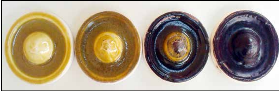
Şekil 4. Uçucu Kül-ÜSSF Karışım Sırların Pişirme Sonuçları (1000 °C)
