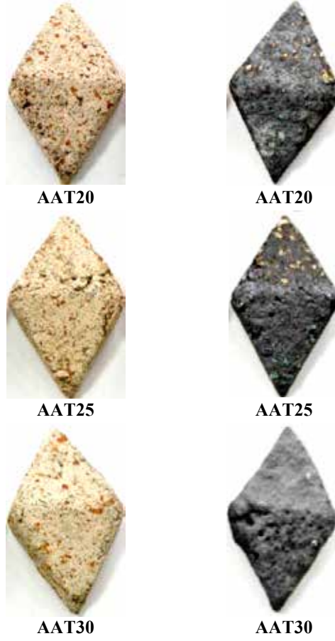
Şekil 6. Akçini Çamuru ve Anahtar Talaşı ile yapılmış temsili deneme tabletleri Figure 6. Representative samples made with china clay and key shavings
