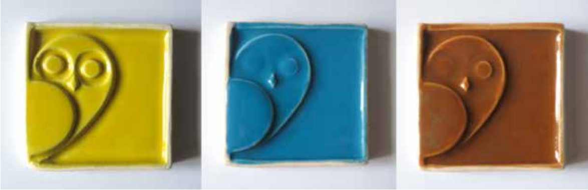
Şekil 3. Sarı, turkuaz ve kahverengi renklere sahip üç ayrı karo sırnın bisküvi plakalar üzerinde 1000 0 C’de deneme pişirimi sonuçları.
